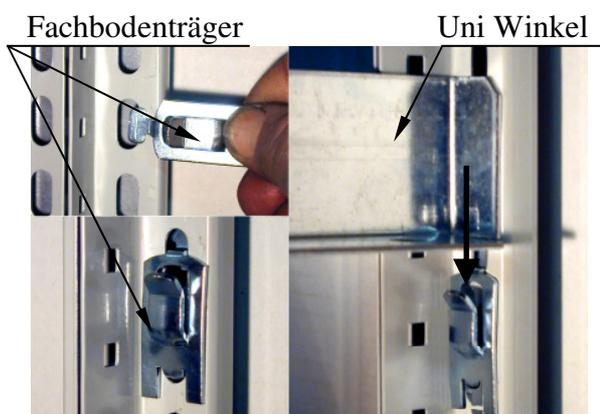
3. Danach werden die diversen Uni-Profile montiert.
